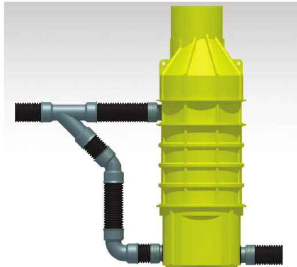
اجرای منهول ریزشی با ارتفاع بالا
